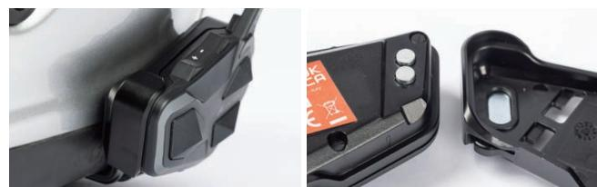
●ベース部と本体との接続はマグネット式でRCF採用モデル間は共通部品。スピーカーの配線はベース部に接続するので本体の脱着が気兼ねなく行えて拡張性も高い。本体のスイッチはとがった形状になっており、グローブをはめたままでも把握しやすくクリック感も良好
