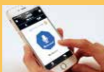
●BT TALKは画面上のボタン、もしくは別売りのBTTボタンを押しながら話すトランシーバー式。電話式のLINE通話よりデータ量を抑えているので状況変化に強い
